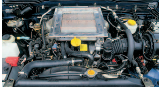
Einer der wenigen langlebigen Turbodiesel: 2,7-Liter-Vierzylinder
