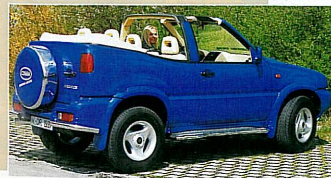
Das hohe Heck erschwert etwas die Rücksicht. Der Kofferraum hat Originalmaße und die hinteren Sitze sind einzeln umklappbar
